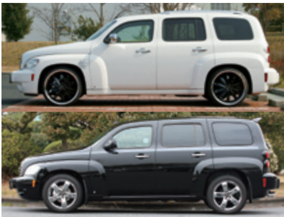
2インチローダウンコイルを使い、実用に支障がない程度に落とされた。下写真がノーマル車高のHHR。
